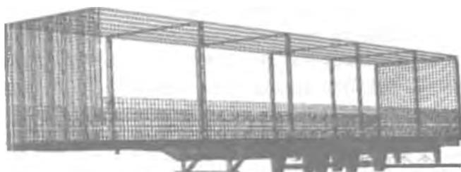
Рис. 14. Конечноэлементная модель рамы полуприцепа с установленными полом, стойками и бортами
