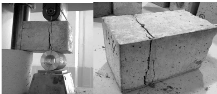
Рис. 2.79. Испытание половинок призм на раскалывание
