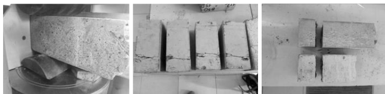
Рис. 2.110. Испытание половинок балочек на растяжение при раскалывании
