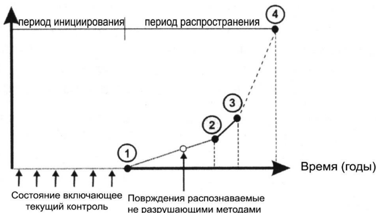
Рис. 3.4. Этапы развития коррозии под действием карбонизации: 1 – Депаассивация арматуры; 2 – Образование трещин; 3 – Отслоение защитного слоя; 4 – Разрушение конструкции в результате потери сцепления между арматурой и бетоном
