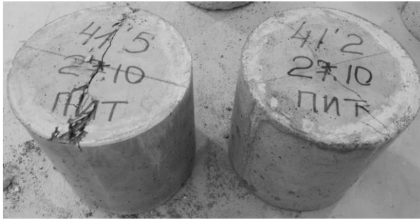
Рис. 2.101. Образец цилиндр состава Г.1 после испытаний на растяжение при раскалывании
