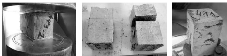
Рис. 2.108. Испытание половинок балочек на сжатие
