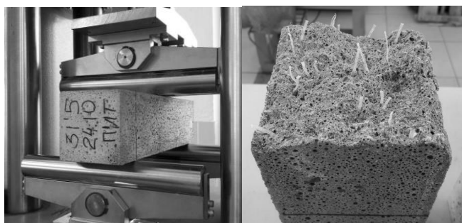
Рис. 2.77. Испытание образцов-призм на растяжение при изгибе
