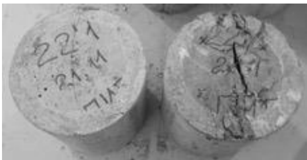
Рис. 2.99. Образец цилиндр состава Б.2 после испытаний на растяжение при раскалывании
