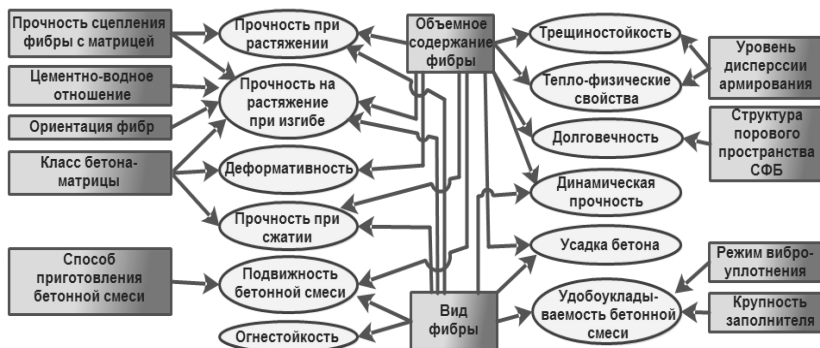
Рис. 2.30. Взаимосвязь между параметрами и физико-механическими свойствами сталефибробетона
