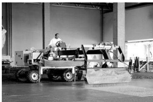
Рис. 2.18. Машина СТС-11М Топпинг Spreader для внесения топпинга [13]
