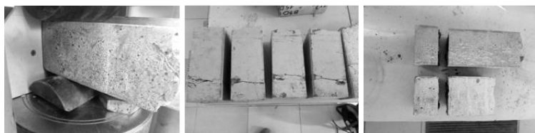
Рис. 2.73. Испытание половинок балочек на растяжение при раскалывании
