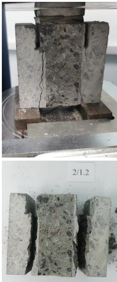
Рис. 1.15. Испытание образца на поперечный сдвиг
