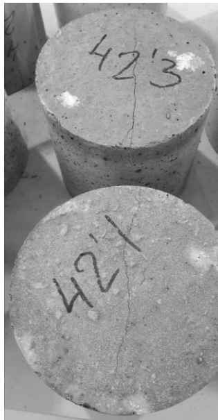
Рис. 2.102. Образец цилиндр состава Г.2 после испытаний на растяжение при раскалывании
