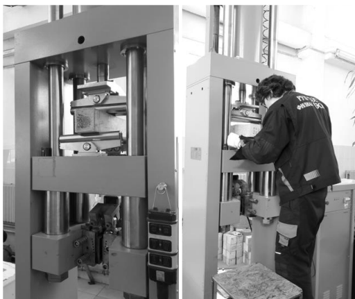
Рис. 2.88. Испытание образцов балок на оборудовании на разрывной машине Controls 70-C0820/C в лабораторном комплексе РУП «Белэнергострой» филиала «Белэнергоиндустрия» на площадке строительства Белорусской АЭС
