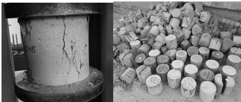
Рис. 2.103. Испытание образца-цилиндра на осевое сжатие
