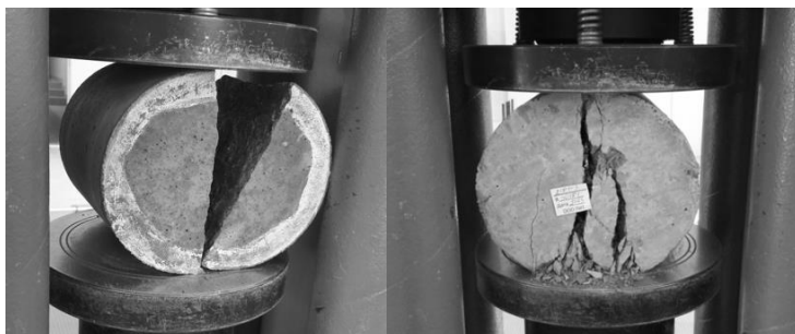
Рис. 2.119. Испытание образцов цилиндров на растяжение при раскалывании без фибрового армирования (слева) и с фибровым полиармированием (справа)
