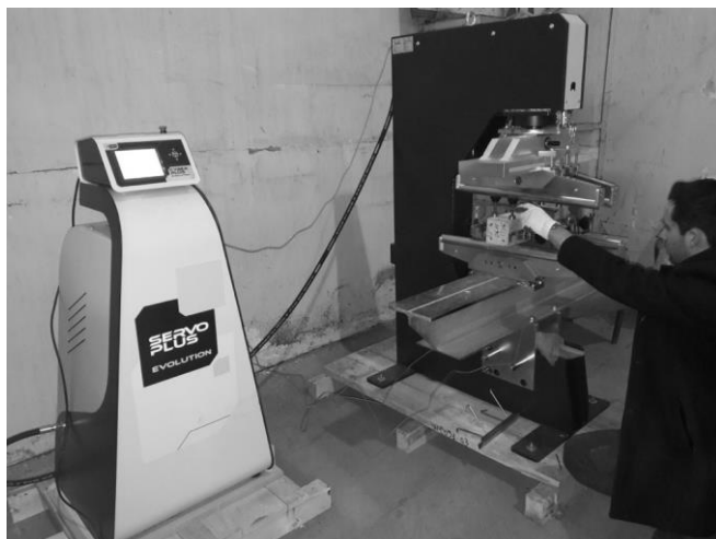
Рис. 2.91. Испытание образцов балок на специализированном оборудовании в научно-исследовательской лаборатории «Промышленное и гражданское строительство» БНТУ
