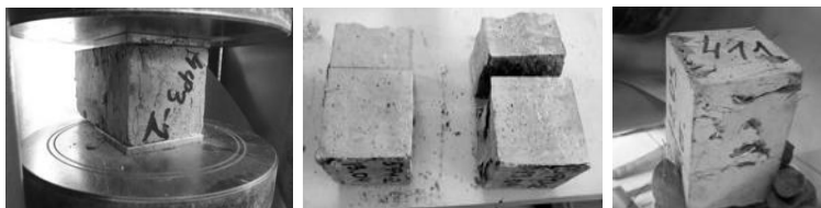
Рис. 2.75. Испытание половинок балочек на сжатие
