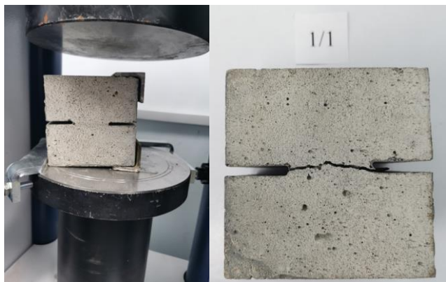
Рис. 1.14. Испытание образца на нормальный отрыв
