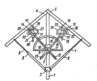
Изобретение относится к чертежным приборам для воспроизведения кривых, в частности для вычерчивания коробовых кривых при сопряжении расположенных под углом прямых, и может быть использовано в учебном процессе вузов.
