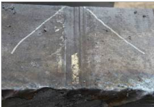
Рис. 3. Внешний вид дефектов на непрерывнолитейной заготовке плавки № 3
