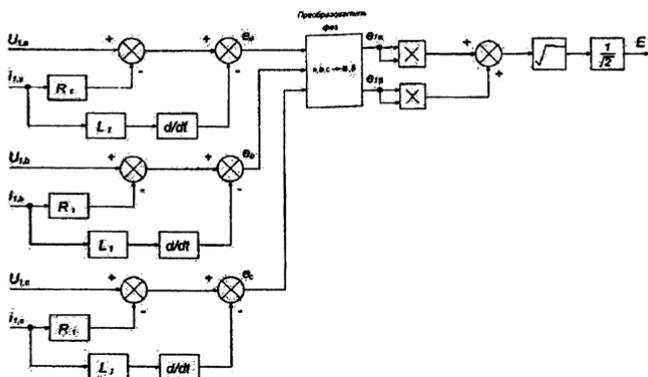
Рис. 1. Структурная схема вычислителя ЭДС
