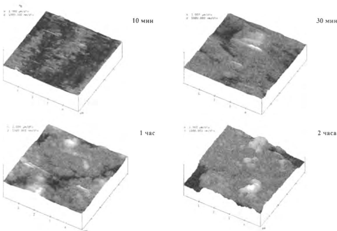
Рис. 4. Изменение морфологии поверхности стали У8 от времени гидрохимической обработки (а).
