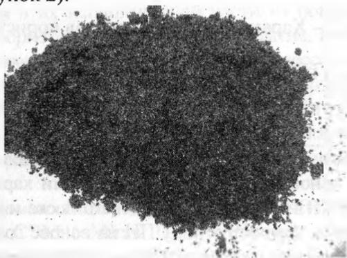
Рисунок 2 – Шихта на основе гранита фракции 200..600 мкм
