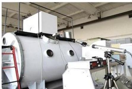
Рисунок 3 – Установка электронно-лучевой обработки
