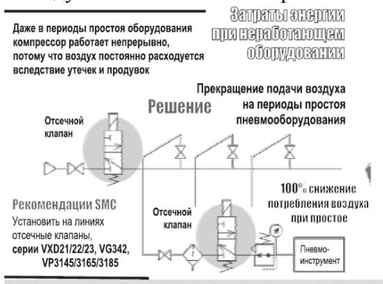
Рисунок 1 – Затраты энергосбережения при неработающем оборудовании
