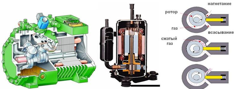
Ротационные компрессоры имеют небольшое число деталей, обладают простой конструкцией, надежностью в эксплуатации, простотой обслуживания, хорошими массогабаритными показателями, относительно низкой стоимостью изготовления. Отсутствие клапанов на всасывании, а в некоторых типах и на линии нагнетания, снижает суммарные газодинамические потери.
