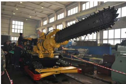
Рис. 4. Машина врубовая баровая МВБ-140
