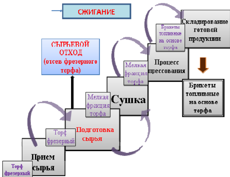
Рис. 1. Схема технологического процесса производства торфяных топливных брикетов
