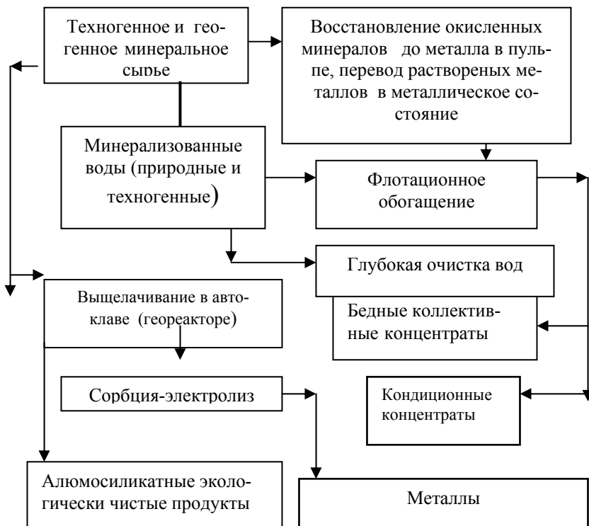
Рис. 2. Принципиальная схема методов и технологических приемов снижения экологической нагрузки на окружающую среду
