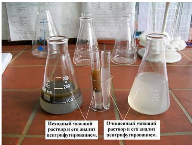
Рис. 3. Эффективность очистки горячего моющего раствора при однократном пропускании его через установку «Флотатор-У».
