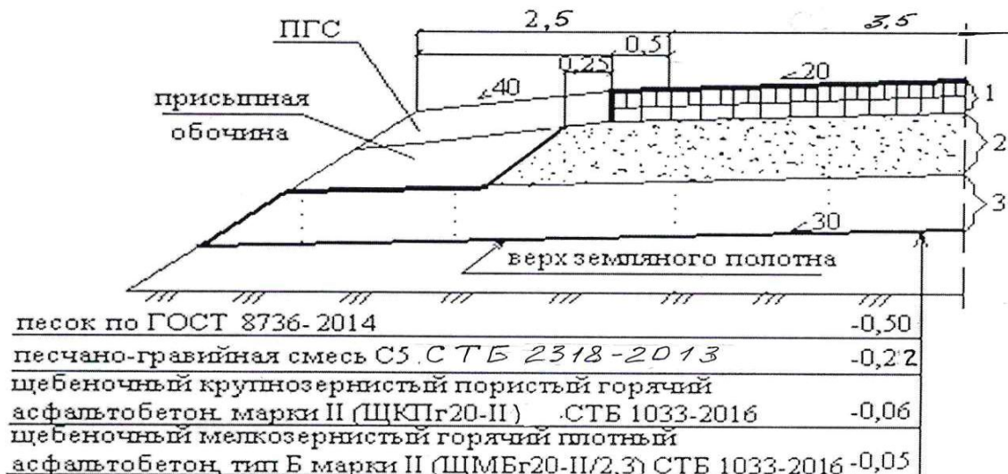
Рисунок 6 - Поперечный профиль дорожной одежды с дренирующим слоем; 1 – покрытие; 2 – основание; 3 – дренирующий слой;
