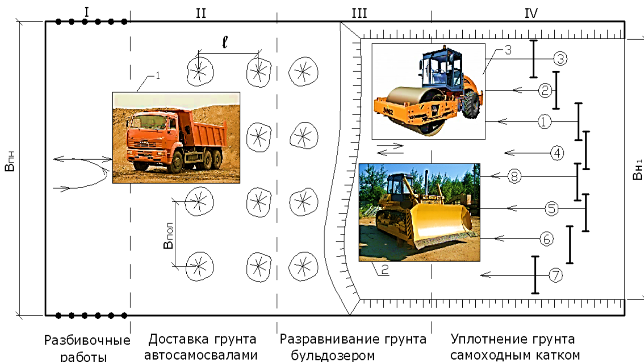
Рис. 1. Технологическая схема работы экскаваторного звена при уплотнении грунта катками по кольцевой схеме: 1 – автосамосвал, 2 –бульдозер, 3- каток, 4- поливочная машина
