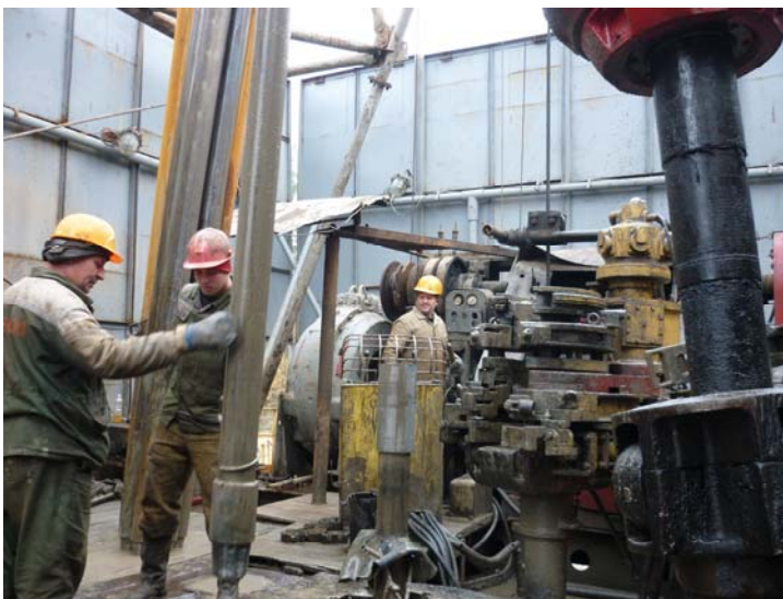
Рис. 2. Бригада буровиков на рабочей площадке ЗД-86 выполняет спуско-подъемные операции
