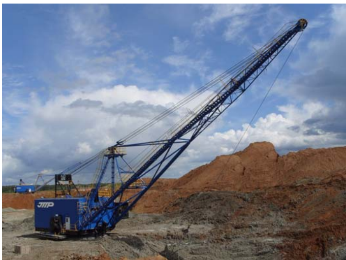
Рис. 5. Машина землеройная шагающая серии МЗШ
