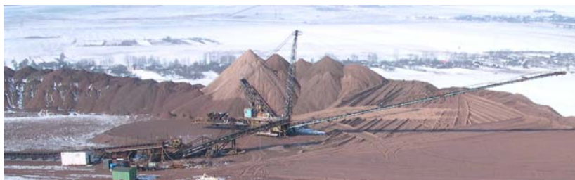
Рис. 6. Солеотвальные конвейеры и отвалообразователи
