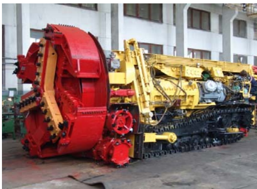
Рис. 1. Комбайн проходческий серии КРП
