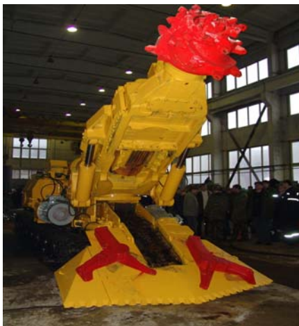
Рис. 3. Комбайн избирательного действия КИД-220
