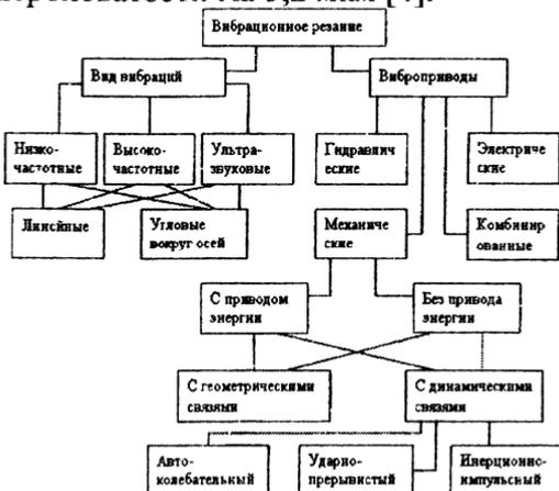
Рисунок 1 – Классификация способов вибрационного резания
