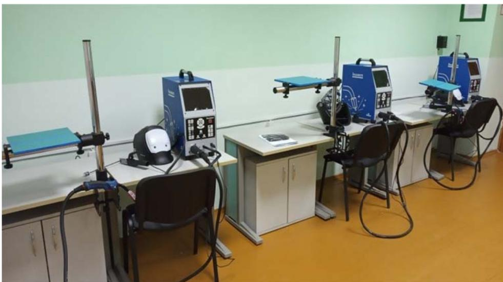
*Фото. 23. Мастерская сварочных работ ресурсного центра ИПК УО РИПО с современными 3D-тренажерами SOLDOMATIK, позволяющими имитировать производственные процессы в дополненной реальности<sup>14</sup>*
