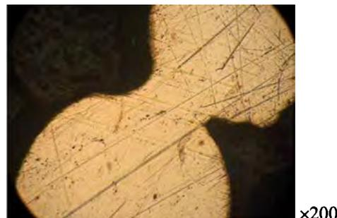
Рис. 6. Форма контакта между частицами порошка после СЛС
