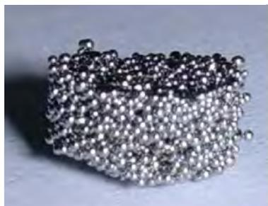
Рис. 4. Полученный образец пористого материала
