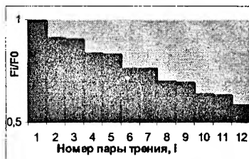
Рис.3. Зависимость F_i/F_0 от удалённости от поршня
