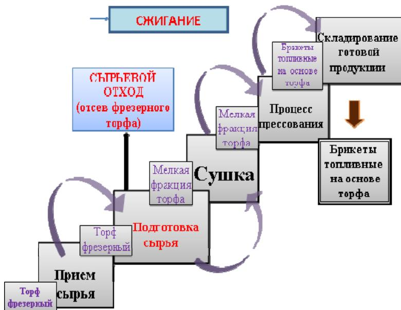
Рис. 1. Схема технологического процесса производства торфяных топливных брикетов
