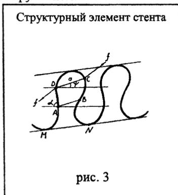
Упруго-пластическая деформация стента определяет такую важную его эксплуатационную характеристику как раскрываемость. Динамика раскрытия стента (раскрываемость) характеризуется величиной давления и временем, необходимым для его полного раскрытия.
