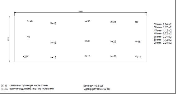
Рисунок 2 — Подтверждающая схема для расчета объема Источник: Собственная разработка автора
