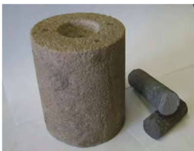
Рис. 2.2. Методика получения клиновой пробы на отбел
