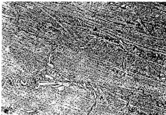
Рис. 7.2. Структура литой жаропрочной стали после эксплуатации 3–4 месяца
