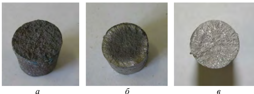
Рис. 1.2. Фотографии макроструктуры серого (а), половинчатого (б), белого (в) чугунов
