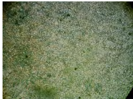
Рис. 1.4. Структура эвтектоидной стали У8: а – пластинчатый перлит; б – зернистый перлит
