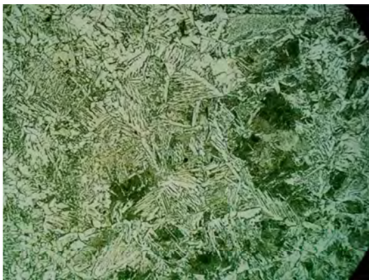
Рис. 1.6. Видманштетовая структура литой доэвтектоидной стали
