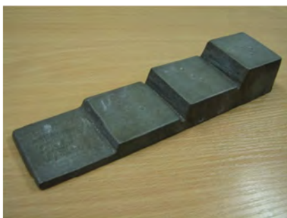
Рис. 2.4. Ступенчатая плита для исследования твердости
