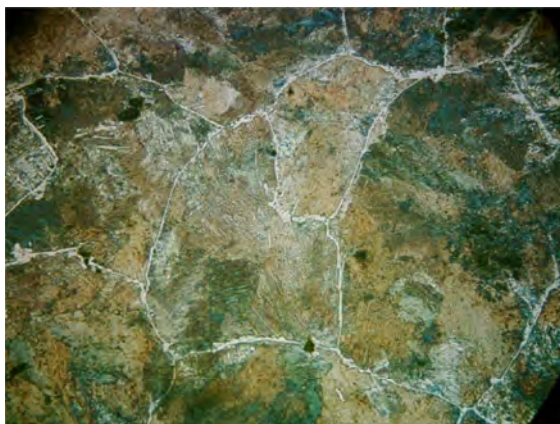
Рис. 1.5. Структура заэвтектоидной стали У12
