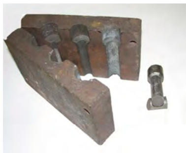
Рис. 2.2. Методика получения клиновой пробы на отбел
