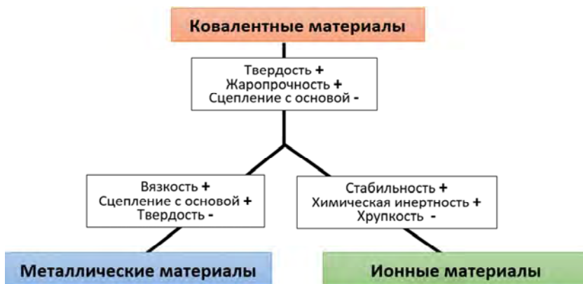
Рис. 3. Изменение свойств материалов покрытий в зависимости от характера химических связей («+» – растет, «-» – снижается)
