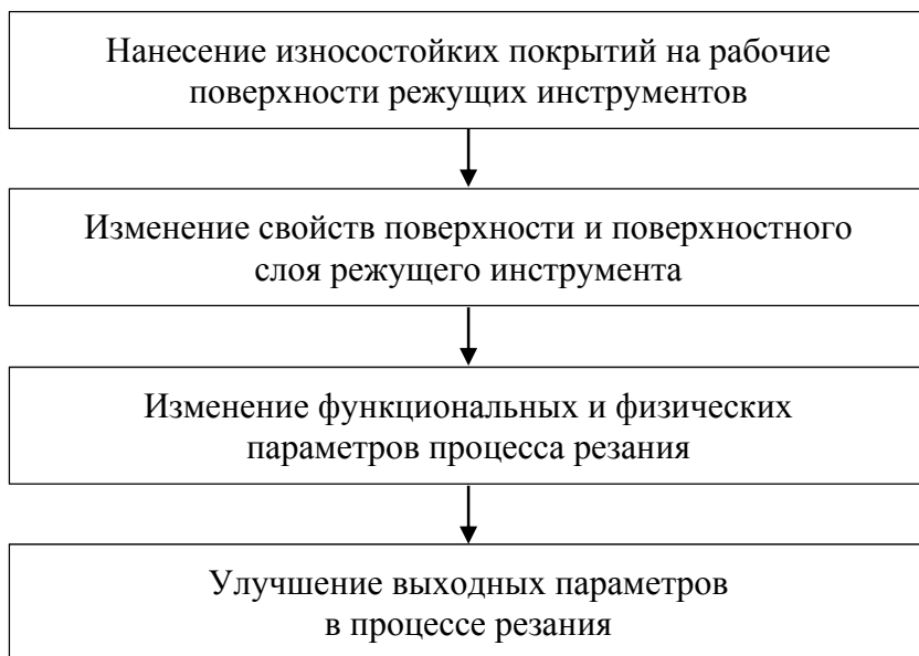
Рис. 1. Эффекты, достигаемые в результате нанесения износостойких покрытий на рабочие поверхности РИ
