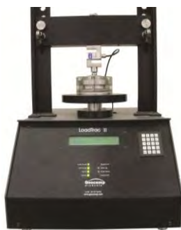
Рис. 2. Автоматизированная система LoadTrac-II для проведения компрессионных испытаний
