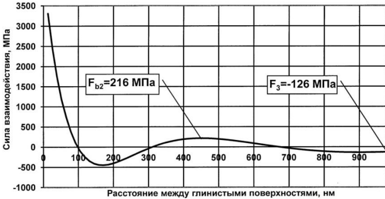
Рис. 2. Реакция контакта типа «базис-базис» на поступательное перемещение параллельных граней глинистых частиц
