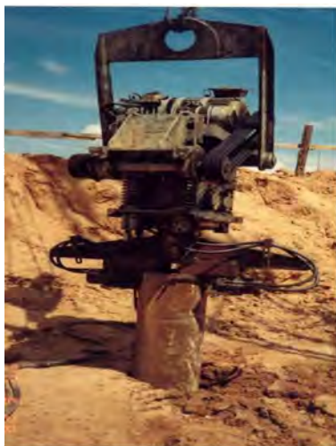
Рис. 1. Проходка скважин для буронабивных свай: а – погружением конического пуансона подвесным вибратором; б – погружением обсадной трубы вибратором на жесткой направляющей станка АВИ
