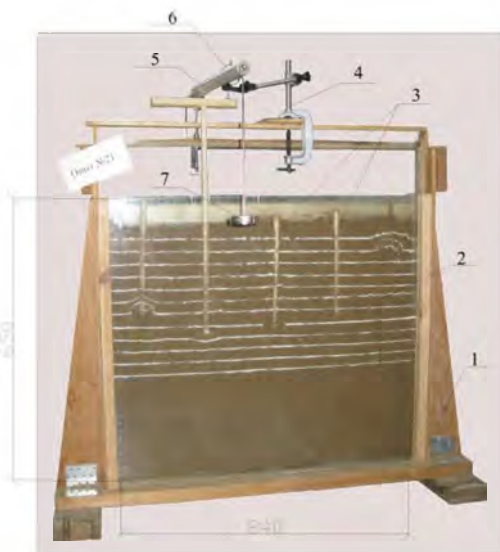
Рис. 2. Общий вид плоского лотка, и модельных свай в процессе их испытаний: 1 – деревянный лоток; 2 – контрольные меловые полоски для оценки деформации грунта; 3 – модель винтовой сваи; 4 – трубочина для крепления индикатора; 5 – рычажное устройство для нагружения модели сваи; 6 – индикатор часового типа; 7 – площадка для грузов массой 100, 200 и 500 г
