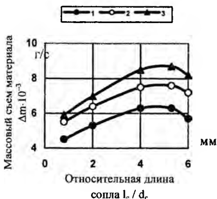
Рис. 5.2. Влияние относительной длины смесительного сопла на величину \Delta m при p_{вх} = 10 МПа; при d_c = 5 мм (3), 4 мм (2), 3 мм (1); угол сходимости 2\alpha = 40^\circ
