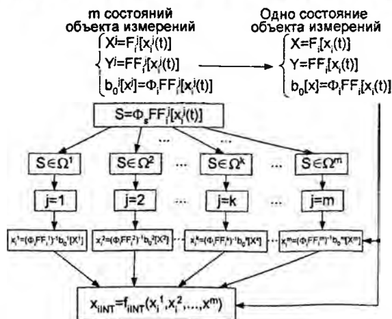
Рис.3.Обобщенная структура односигнальной адаптивной модели измерений
