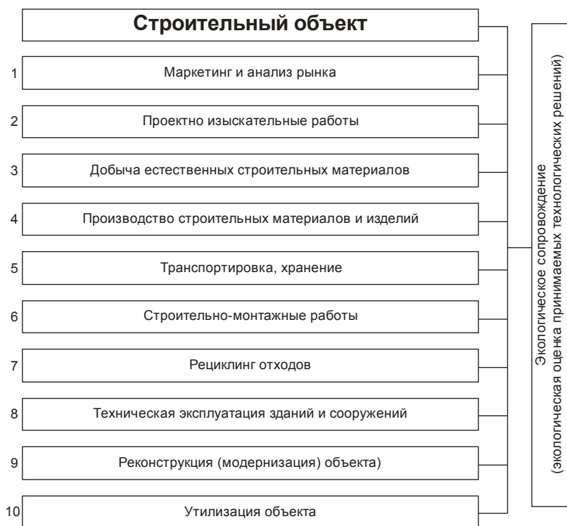
Рис. 2. Основные стадии жизненного цикла строительного объекта
