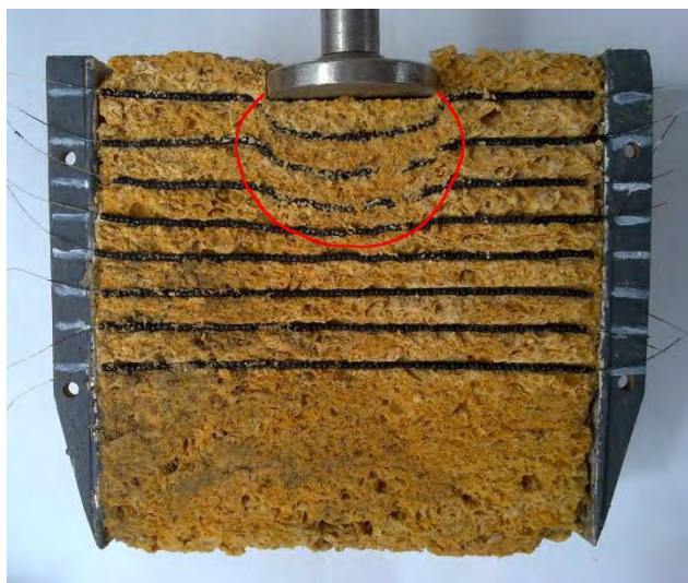
Рис. 1. Характер деформирования известняка-ракушечника под опытным штампом
