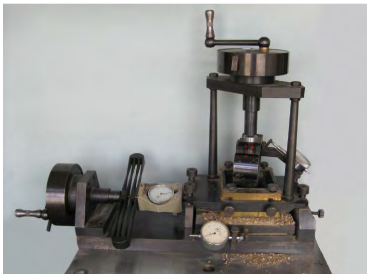
Рис. 1. Общий вид дилатометрического прибора контактного сдвига
