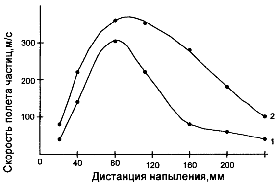
Расход газов, м 3 /час.: 1 – 3,5; 2 – 5,5 . Рисунок 2. Зависимость скорости полета частиц керамики от расстояния от среза сопла
