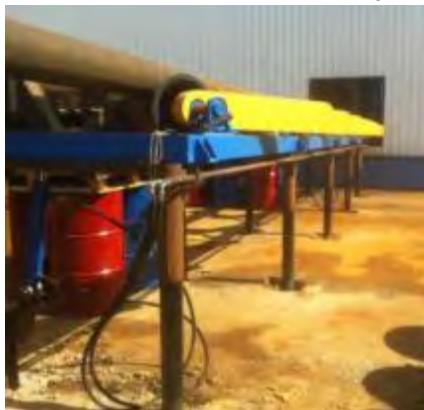
Рис. 1. Разработанные варианты свай СВ по ТУ ВУ 191301472.003-2012 (а) и примеры возведения объектов с их использованием (б), (в): б – щитовой дом на сваях СВ в процессе возведения; в – конвейер для подачи труб в пескоструйный цех
