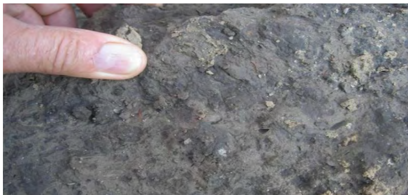
Рис. 2. Структура грунтоцемента при двукратной проходке и скоростях вращения инструмента 35 об/мин. и осевого перемещения, 5 м/мин.
