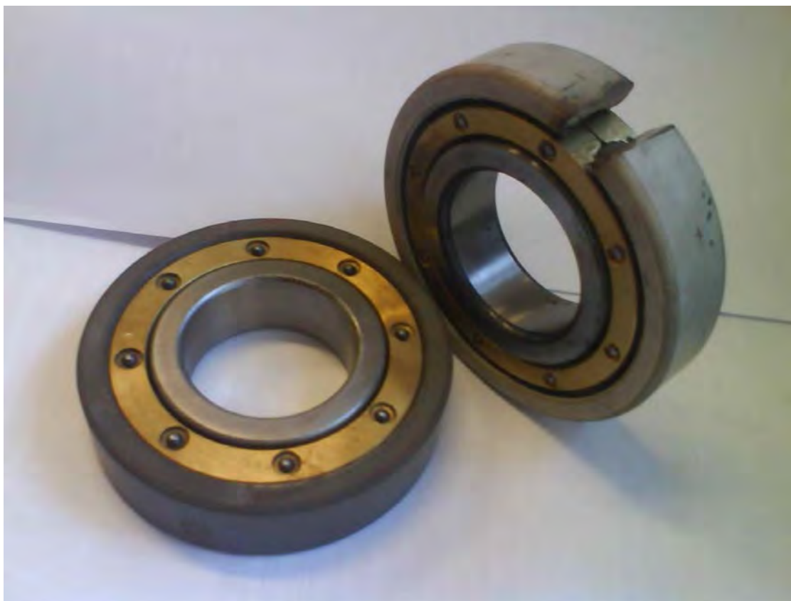
Рис. 2. Подшипники качения с керамическим покрытием, нанесенным на наружное кольцо
