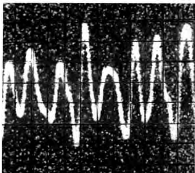
Рис. 1. Оциллограмма переменной составляющей электрического тока (0,5 мкс/дел; 5,33 А/дел)
