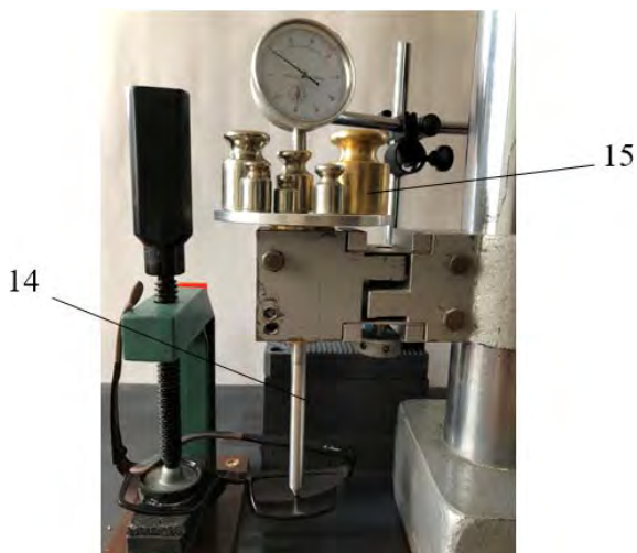
Рис. 3.9. Фотография стенда с установленными гирями: 14 – штырь; 15 – набор гирь
