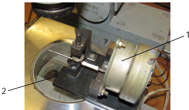
Рис. 2.12. Фотография устройства для измерения радиального биения боров и алмазных головок, установленного на столе микроскопа
