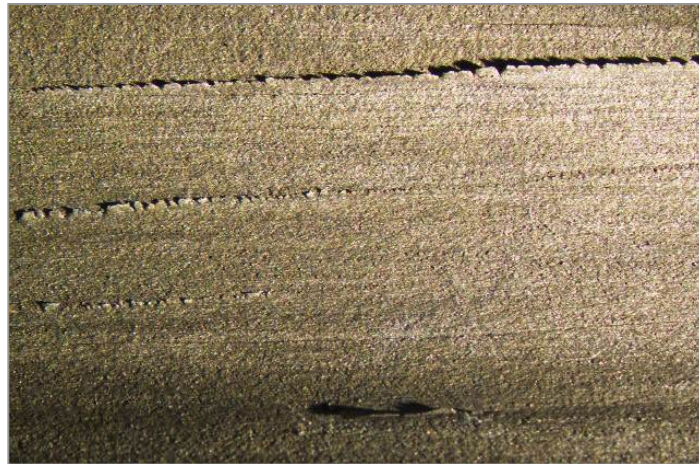
Рис. 5. Внешний вид трубопрокатных плен по причине износа прошивной оправки
