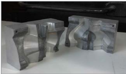
Рис. 25. Стержневая оснастка для производства отливки «Реактор 3301709155»
