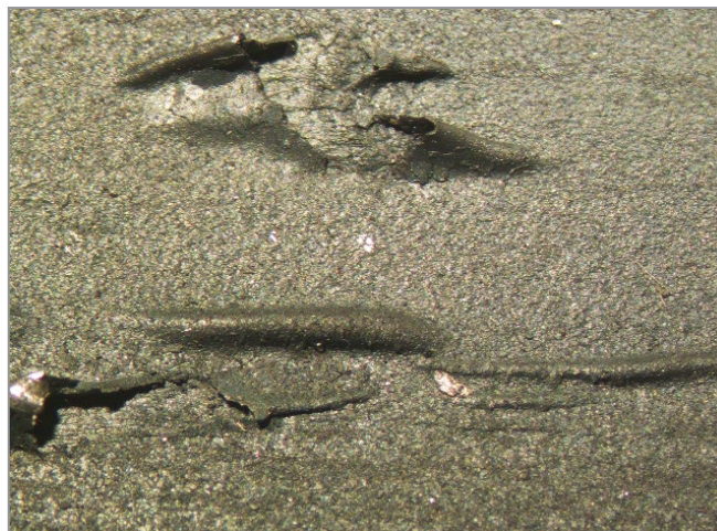
Рис. 3. Внешний вид трубопрокатных плен и вздутий по причине неудовлетворительной настройки прошивного стана
