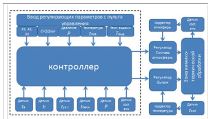
Рис. 33. Функциональная схема регулирования топливной печи химико-термической обработки
