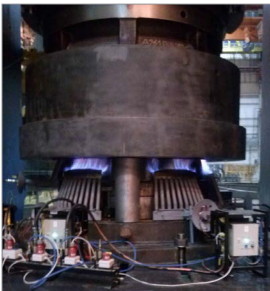
Рис. 3. Установка нагрева штампов
