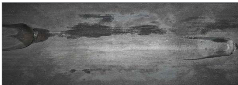
Рис. 9. Внешний вид трубопрокатных плен по причине повреждения внутренней поверхности гильзы штифтом
