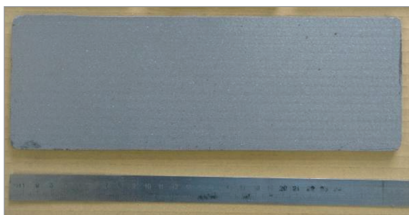
Рис. 31. Прессовка из резистивного сплава состава РС 1004
