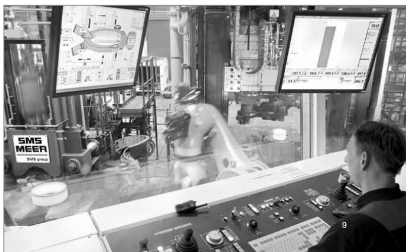
Рис. 2. Пульт управления системой ЧПУ кольцераскатной установки
