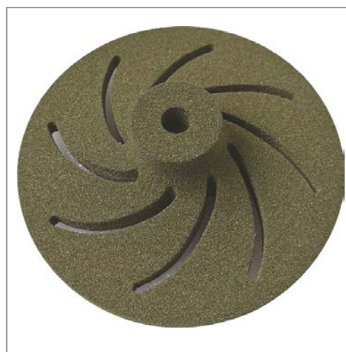
Рис. 5. Литейный стержень рабочего колеса
