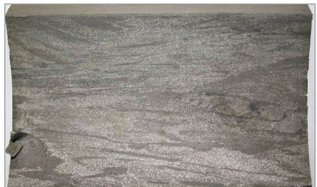
Рис. 7. Внешний вид трубопрокатных плен по причине попадания воды на внутреннюю поверхность гильзы
