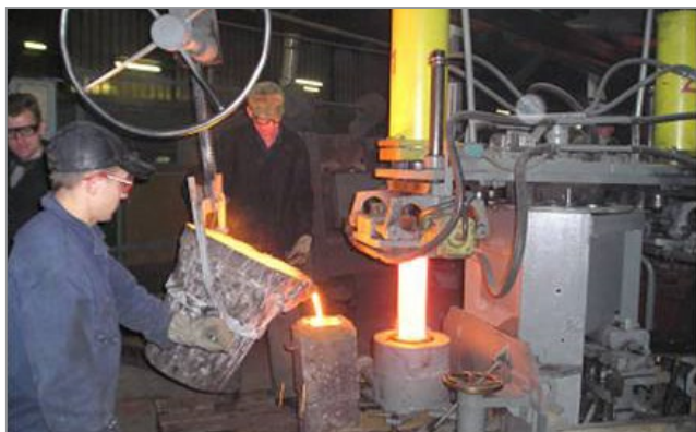
Рис. 18. Установка и оборудование для непрерывного литья намерзанием
