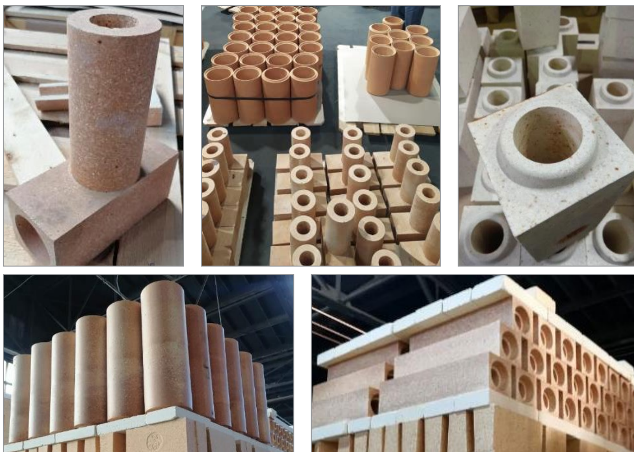
Рис. 4. Высокоглиноземистые изделия марки МЛС-67 производства АО «БКО»
