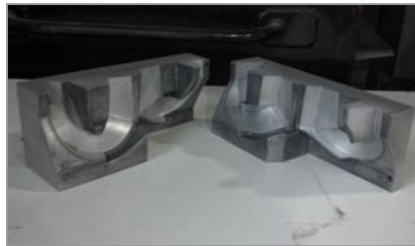
Рис. 26. Стержневая оснастка для производства отливки «Колесо насосное 330179101»
