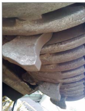
Рис. 21. Фрагмент барабана молотковой дробилки
