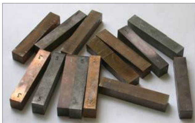
Рис. 6. Композиционный материал-донор для формирования теплостойких покрытий
