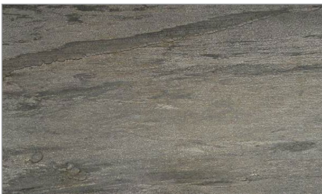
Рис. 7. Внешний вид трубопрокатных плен по причине попадания воды на внутреннюю поверхность гильзы
