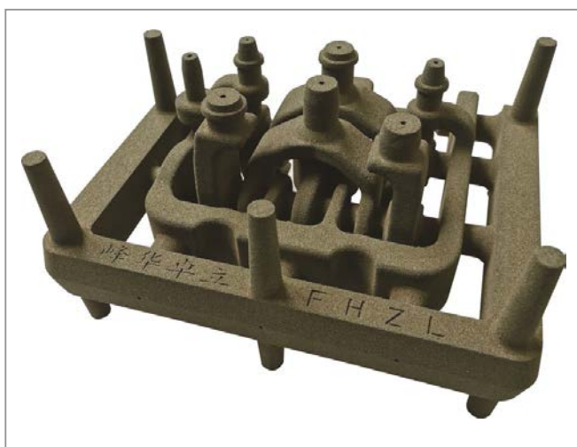
Рис. 4. Литейный стержень клапана
