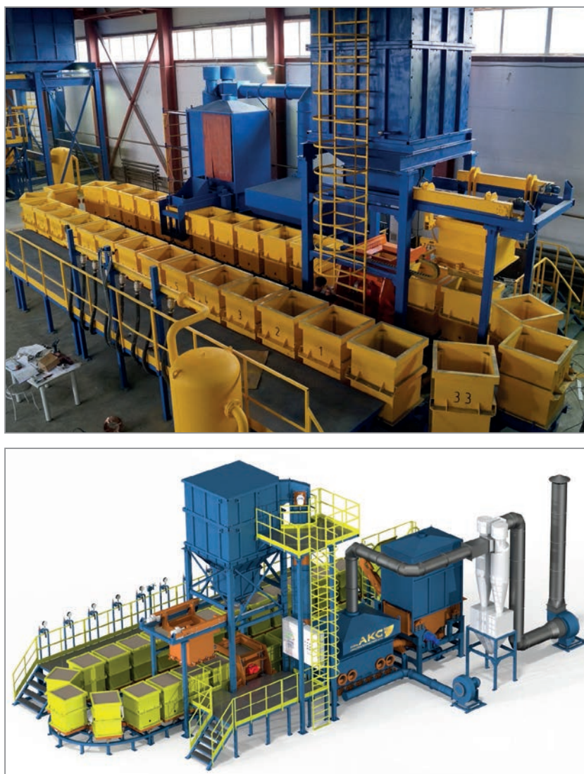
Рис. 2. Автоматическая линия производительностью до 60 форм в час (поставлена в Японию по техническому заданию)
