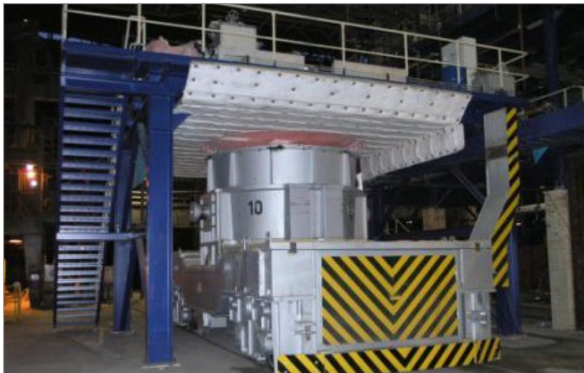
Рис. 2.. Стенд нагрева ковшей
