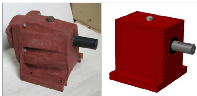
Рис. 3. Пример декомпозиции – мотор редуктора: а – литой корпус редуктора, б – предлагаемое решение сборки из плоских заготовок
