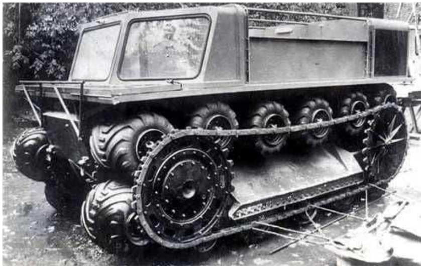
Рис.2. Катково-гусеничный движитель вездехода ЗИЛ-3906
