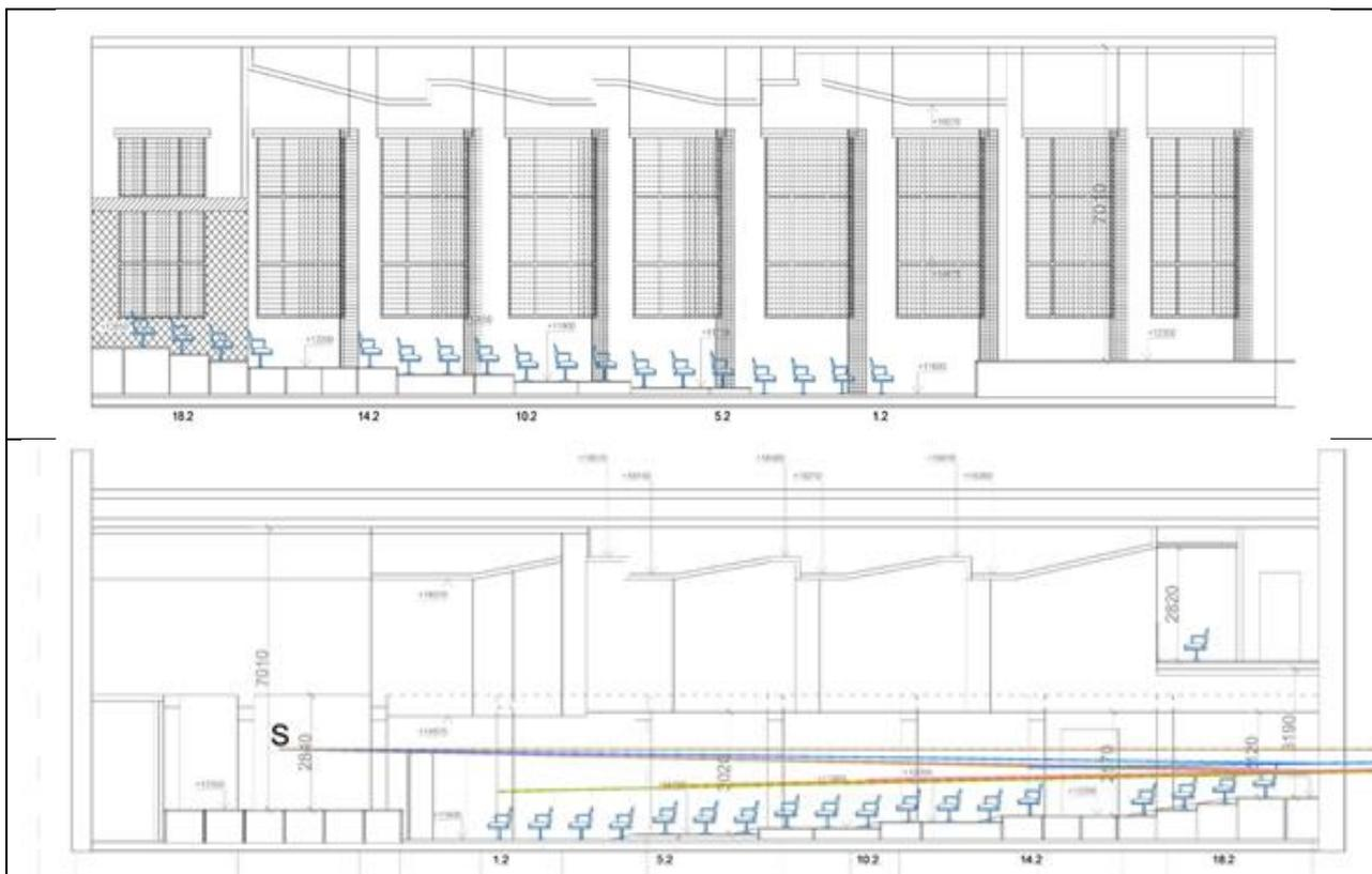
Рисунок 5. Продольный разрез зала и вид продольных стен.
