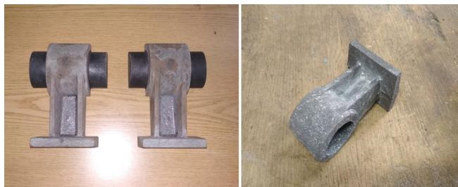
Рис. 5.15. Деревянная модель и отливка
