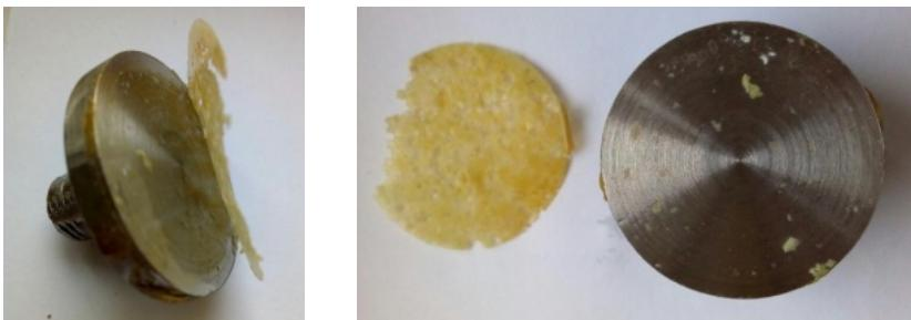
Рис. 6.18. Вид образца с отслоившимся от подложки адгезивом
