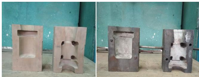
Рис. 5.16. Модели из пластика и отливки
