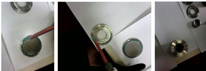
Рис. 4.8. Постепенный процесс склеивания фильтра
