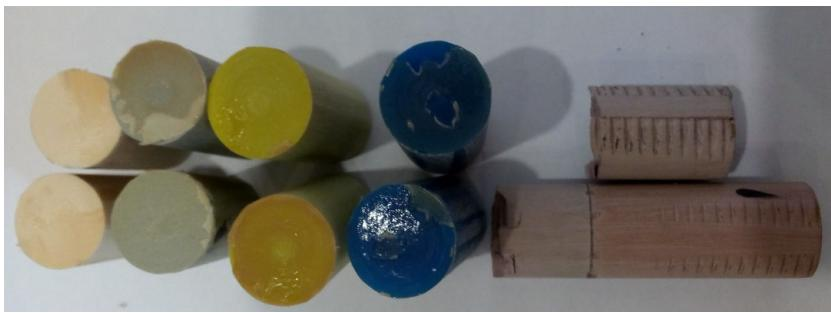
Рис. 5.6. Внешний вид одной из групп образцов пластик/пластик, склеенных kleem UR 3569
