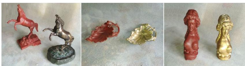
Рис. 5.14. Восковые модели и отливки
