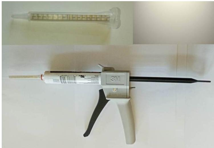
Рис. 3.8. Ручной аппликатор для двухкомпонентных kleев с насадкой
