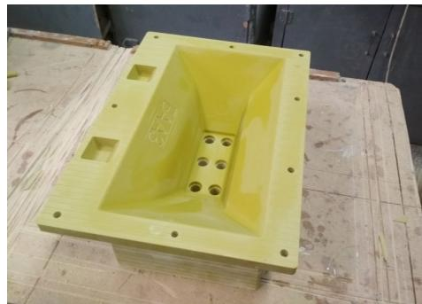
Рис. 5.27. Модель отливки «Корпус»
