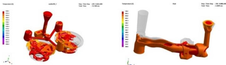
Рис. 5.18. Имитационное моделирование процесса заливки и кристаллизации отливки
