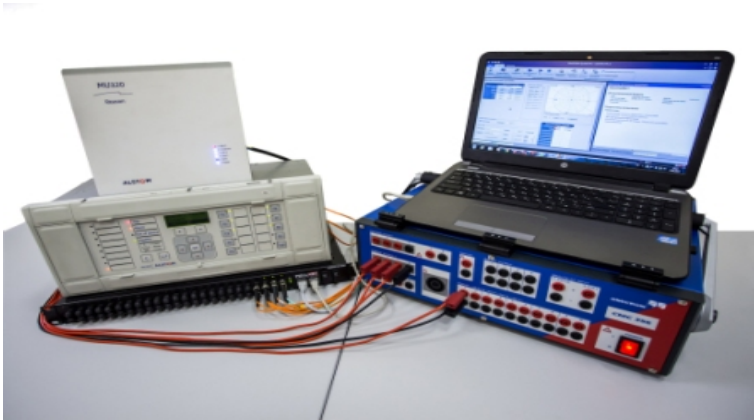
Рис. 1.3. Устройство OMICRON CMC 356 и испытываемое микропроцессорное реле
