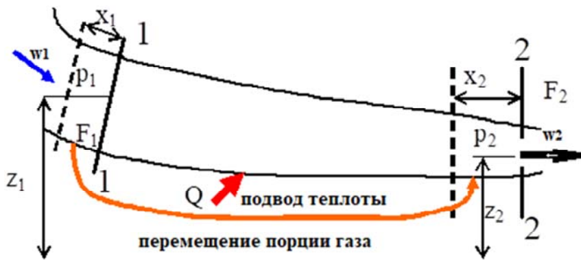
Рис. 3. Канал с движущимся потоком газа
