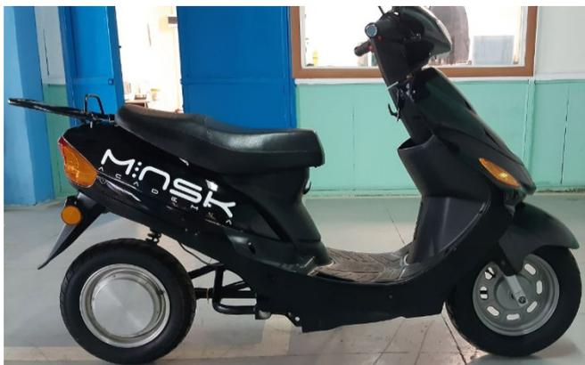
Рисунок 2 – Опытный образец электроскутера
