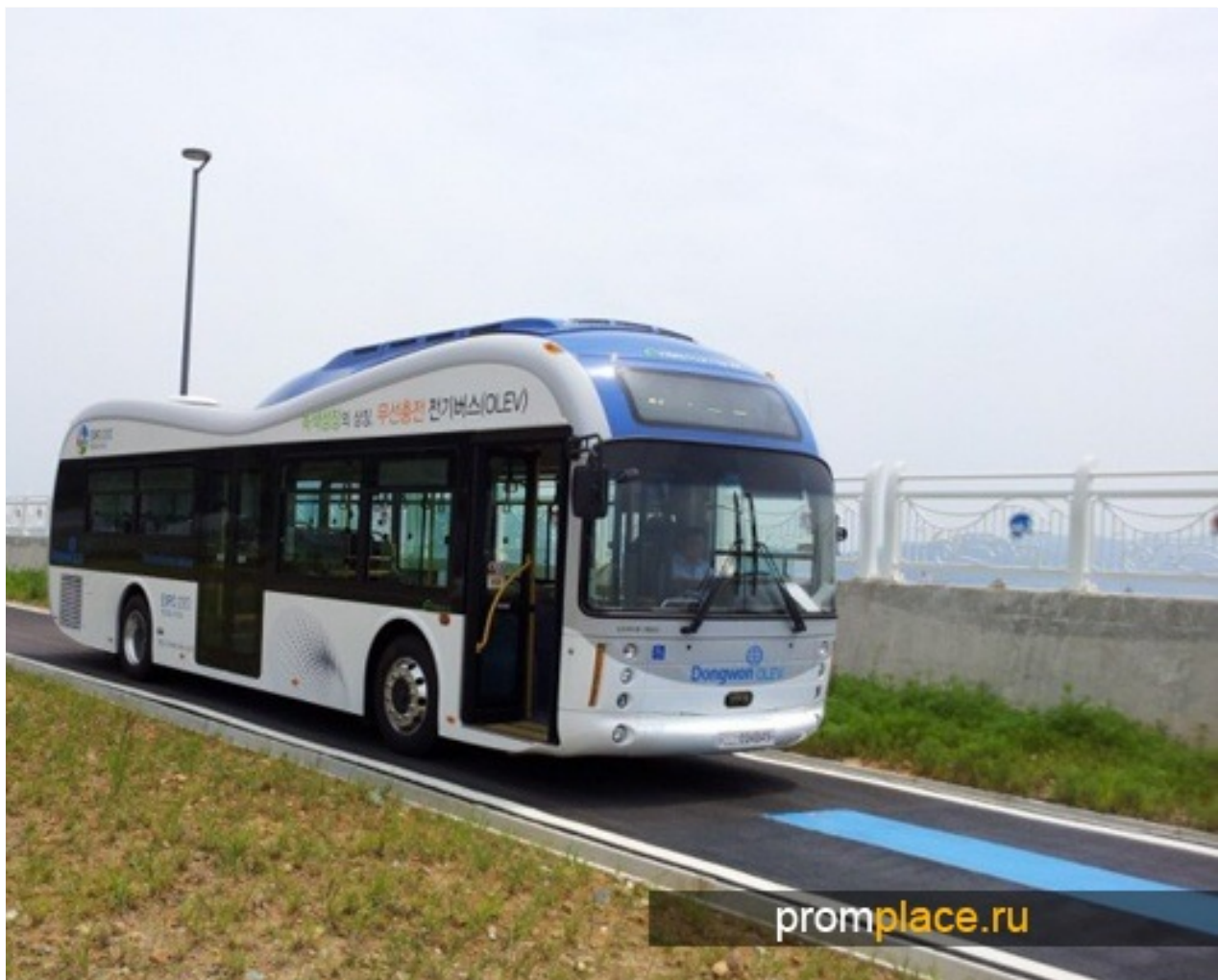
Рисунок 1 – Автобус над электромагнитной полосой
