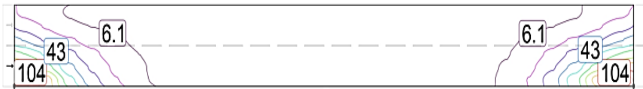
Рисунок 6 – Распределение освещенности по поверхности дороги с использованием светильника GALAD 160 Вт с расстоянием между опорами 80 м
