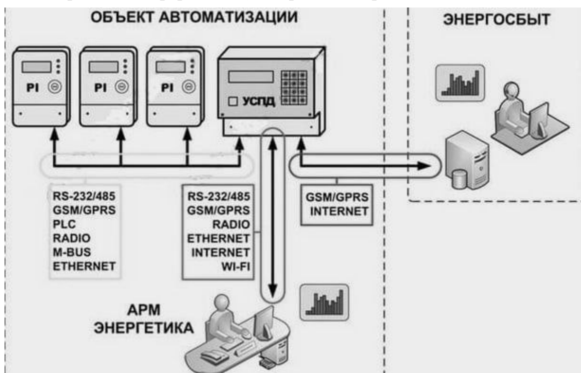
Рисунок 3 – Структурная схема АСКУЭ
