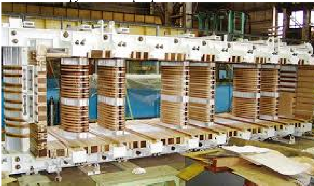
Рисунок 2 – Магнитная группа УШР трёхфазного исполнения
