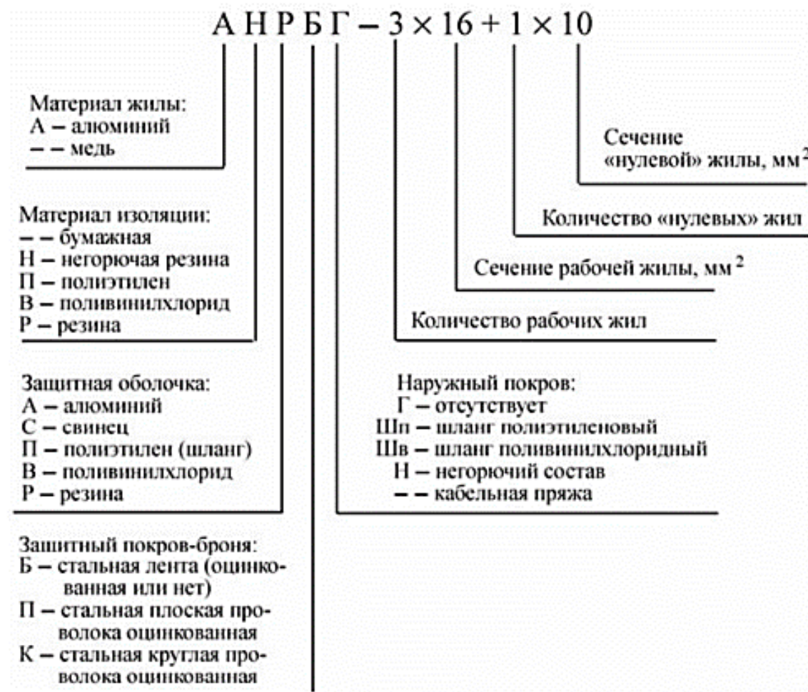
Рисунок 2 – Маркировка силовых кабелей
