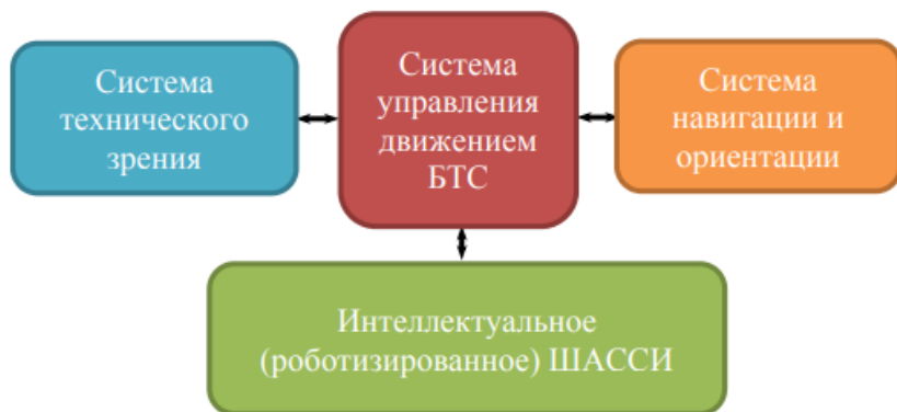
Рисунок 1 – Типовая функциональная схема основных подсистем автоматической системы управления БТС.
