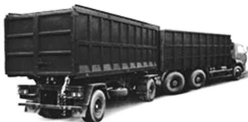
Рис.6. Автопоезд для доставки щепы на котельную
