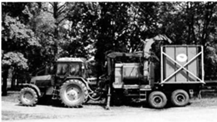
Рис. 4. Рубильная машина, оборудованная бункром-накопителем
