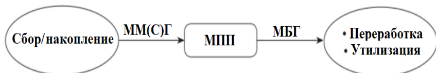
Рис. 2. Блок-схема двухэтапной системы сбора и транспортирования ТКО: ММ(С)Г – мусоровозы малой (средней) грузоподъемности; МПП – мусороперегрузочный пункт; МБГ – мусоровозы большой грузоподъемности (как правило, максимальная масса загружаемых отходов превышает 15 т)
